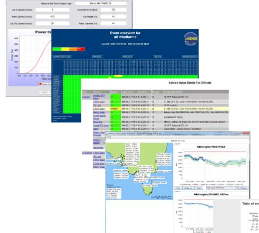
Komponenten des operationellen Anemos-System (von links nach rechts): Vom Anemos.Setup über SCADA und NWP feed checker, Serverüberwachung, Vorhersagen für Australien (Verlauf der Vorhersage (grün) und der zugehörigen Prognoseunsicherheit (90%, hellgrünes Band)) bis zur Evaluierung der Vorhersagegenauigkeit mittels Anemos.Report.
