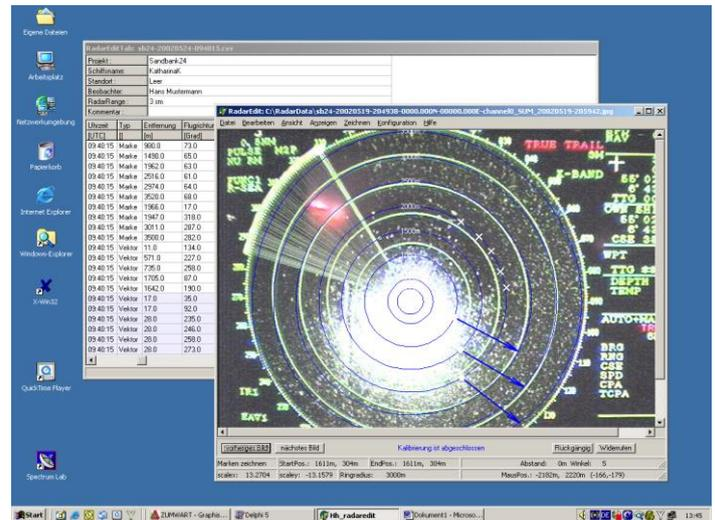
**RadarCam** erlaubt die Bildaufzeichnung, Integration und deren komfortable Konfiguration. Die Aufzeichnungssoftware läuft unter Windows.
